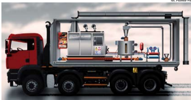
Przyszłością wydają się przewoźne kotłownie kontenerowe transportowane pojazdem hakowym.
